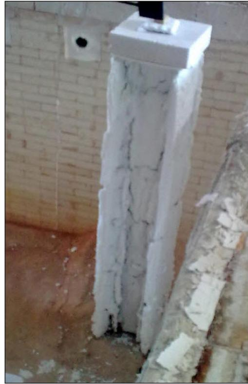
*Pilares largos antes y después del ensayo de intumescencia en horno a 500 °C*
