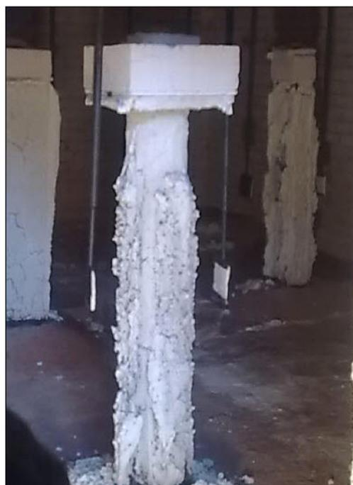
*Pilares cortos antes y después del ensayo de intumescencia en horno a 500 °C*
